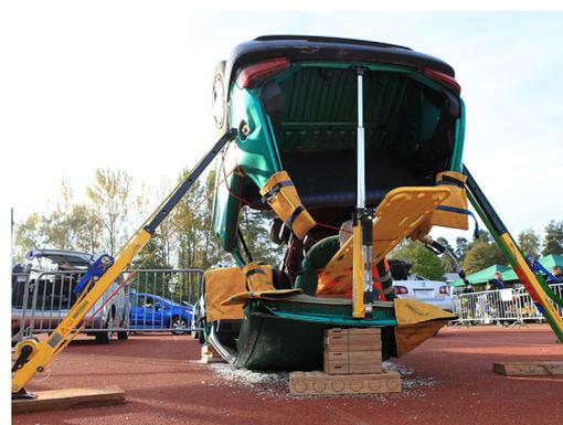
A partir de ahora los RAMS de Weber tendrán marcas en el pistón que indicarán la distancia remanente dentro del cilindro. Esto tiene como objeto que el operador conozca de antemano hasta adonde va a poder deformar la pieza antes que le haga tope.
